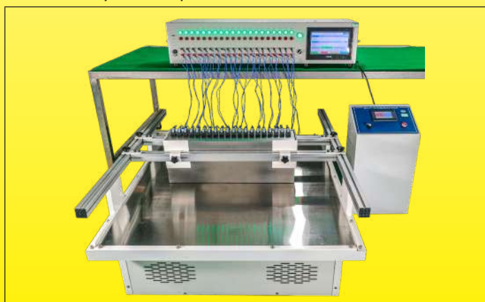
Equipo de ensayo para medir la resistencia a las vibraciones de los interruptores de aire y el contacto de acción lenta de los presostatos mediante simulación de las condiciones de transporte (Laboratorio Ultimheat)
